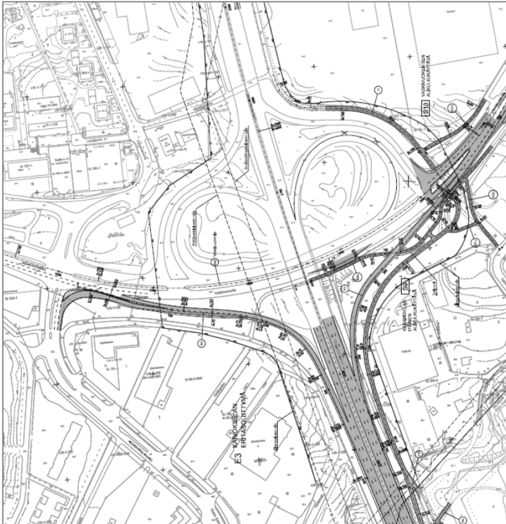
Kuva 4 Kaivoksen eritasoliittymän vuoden 2009 tiesuunnitelman mukaiset kehittämistoimenpiteet.
