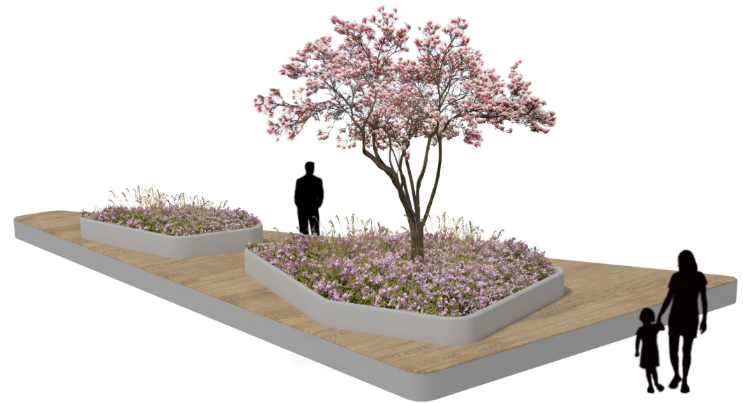
▲ Periaatekuva erikoiskalusteratkaisusta, joka mahdollistaa sekä monipuolisen oleskelun että kansialueelle sijoitettaville istutuksille riittävän kasvualustapaksuuden.
