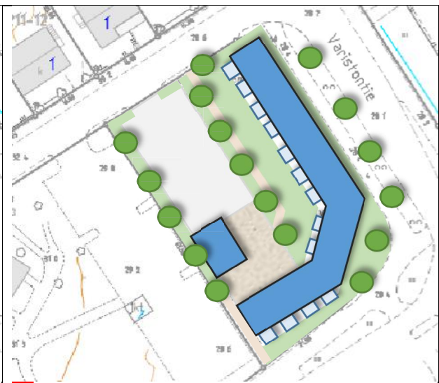
B. Rivitalo, 2½ kerrosta, 1600 k-m 2 , e = 0,67. Rakennus tekee kulman. 14 – 16 asuntoa.
