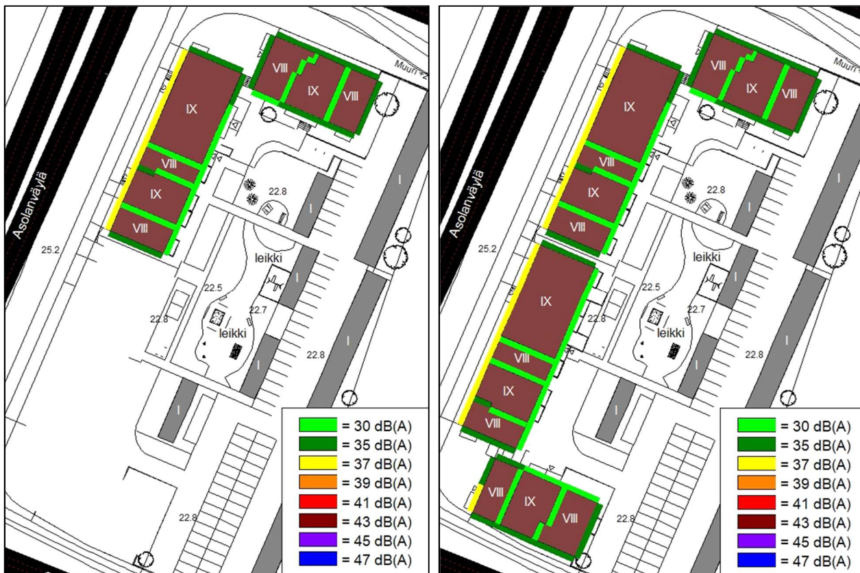
Kuva 5. Asuinhuoneistojen julkisivujen ääneneristävyysvaatimukset rakentamisen eri vaiheissa.
