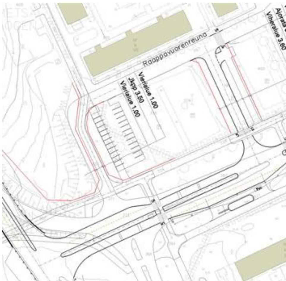
Autopaikkojen sijoitusehdotus katusuunnitelmassa. Kuva: Ramboll Oy
