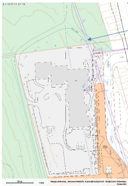
Kuva 8: Alueen vesi-, viemäri- ja kaukolämpöjohdot (kuvassa olemassa olevan Patotien päiväkoti)
