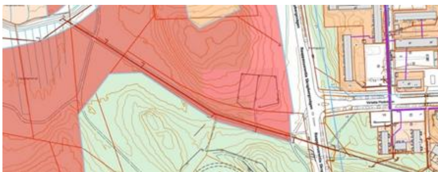
Kuva 1: Alueen vesi-, viemäri- ja kaukolämpöjohdot
