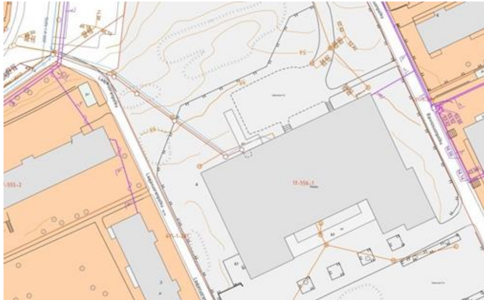
Kuva 1; nykyiset kaukolämpö-, vesi-, viemäri- ja hulevesitonttijohdot
