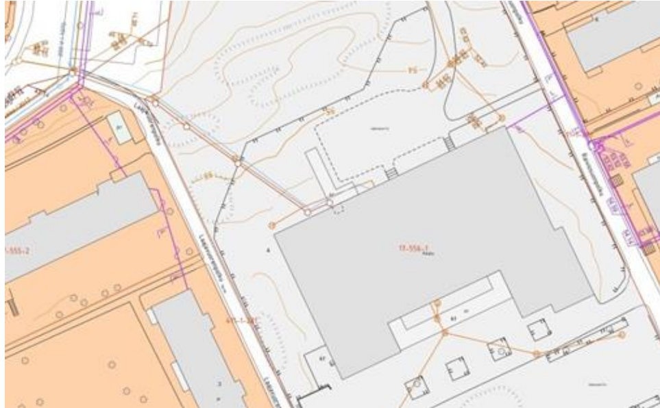
Kuva 1; nykyiset kaukolämpö-, vesi-, viemäri- ja hulevesitonttijohdot
