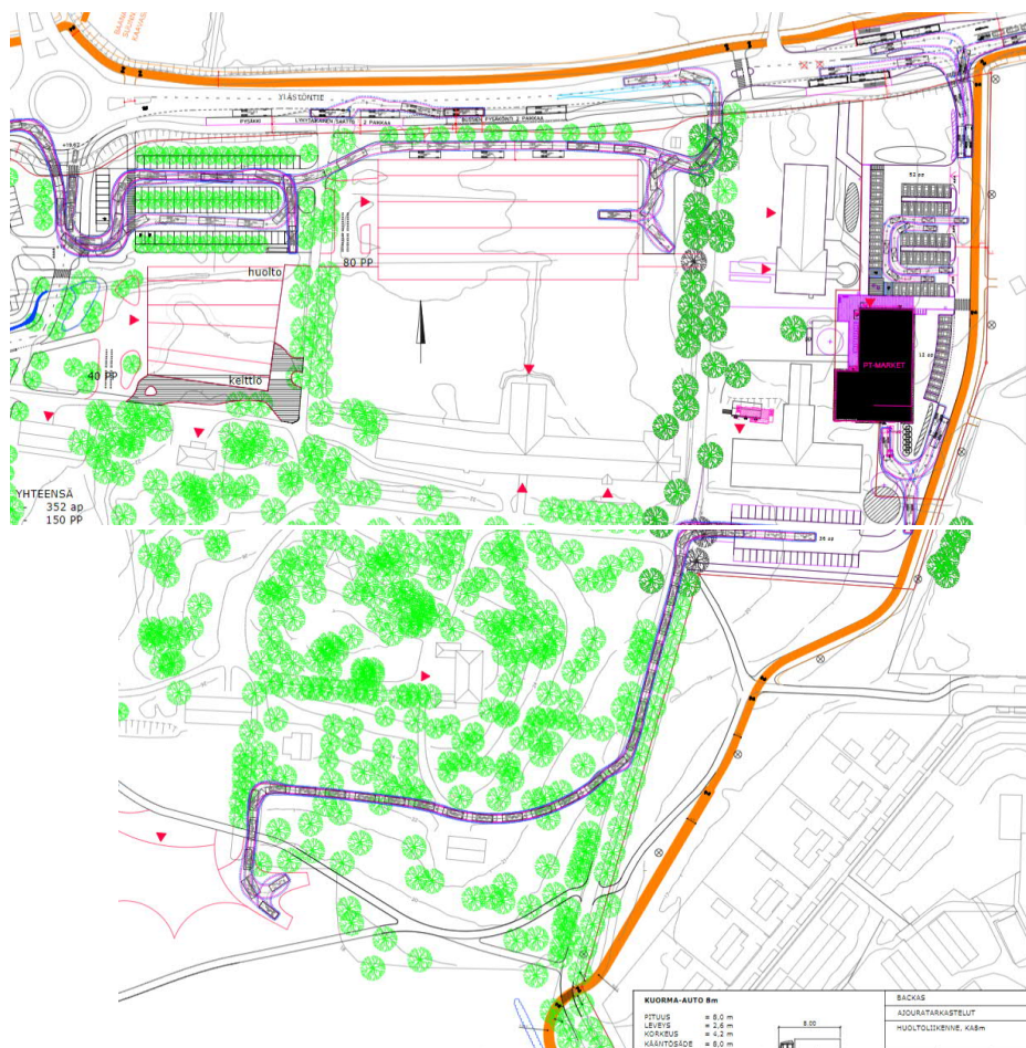
Huoltoauton ajouratarkastelut sekä baanareitti /WSP
