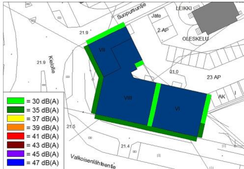
Kuva 3. Asuinhuoneistojen julkisivujen äänitasoerovaatimukset liikenteen melua vastaan.
