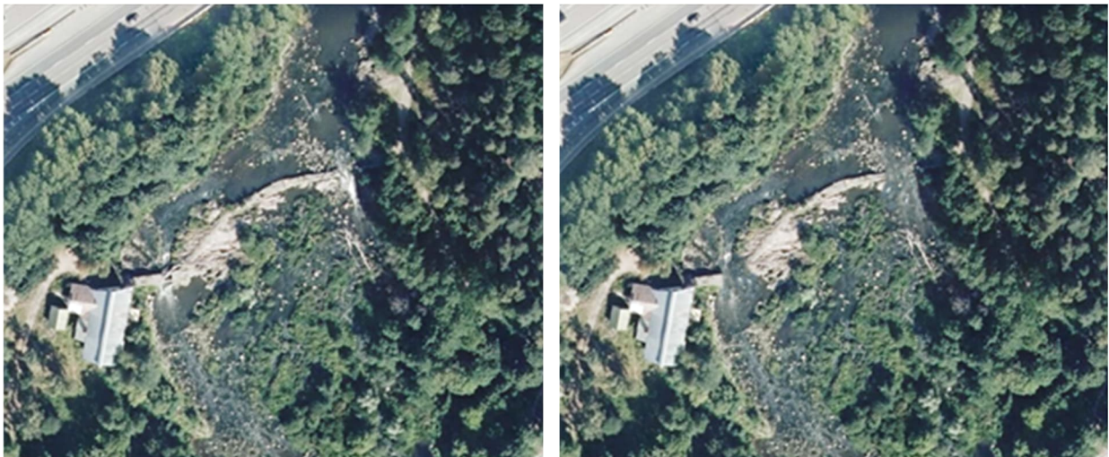
Padon osittainen purkaminen. Vasemmalla nykytila, oikealla osin purettuna.
