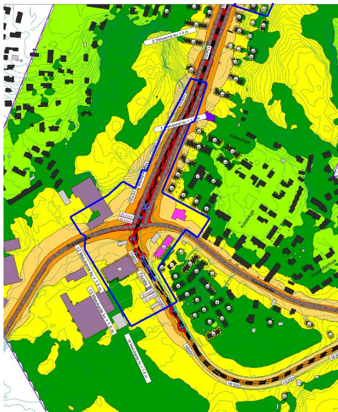
Kuva 32. Ote tieliikennemelun ja raitiotien yhteismelun päiväaikaisesta ennustetilanteesta Tilustiellä, jonne on esitetty melusuojuksi melukaiteita. (Sitowise Oy 31.8.2022)
