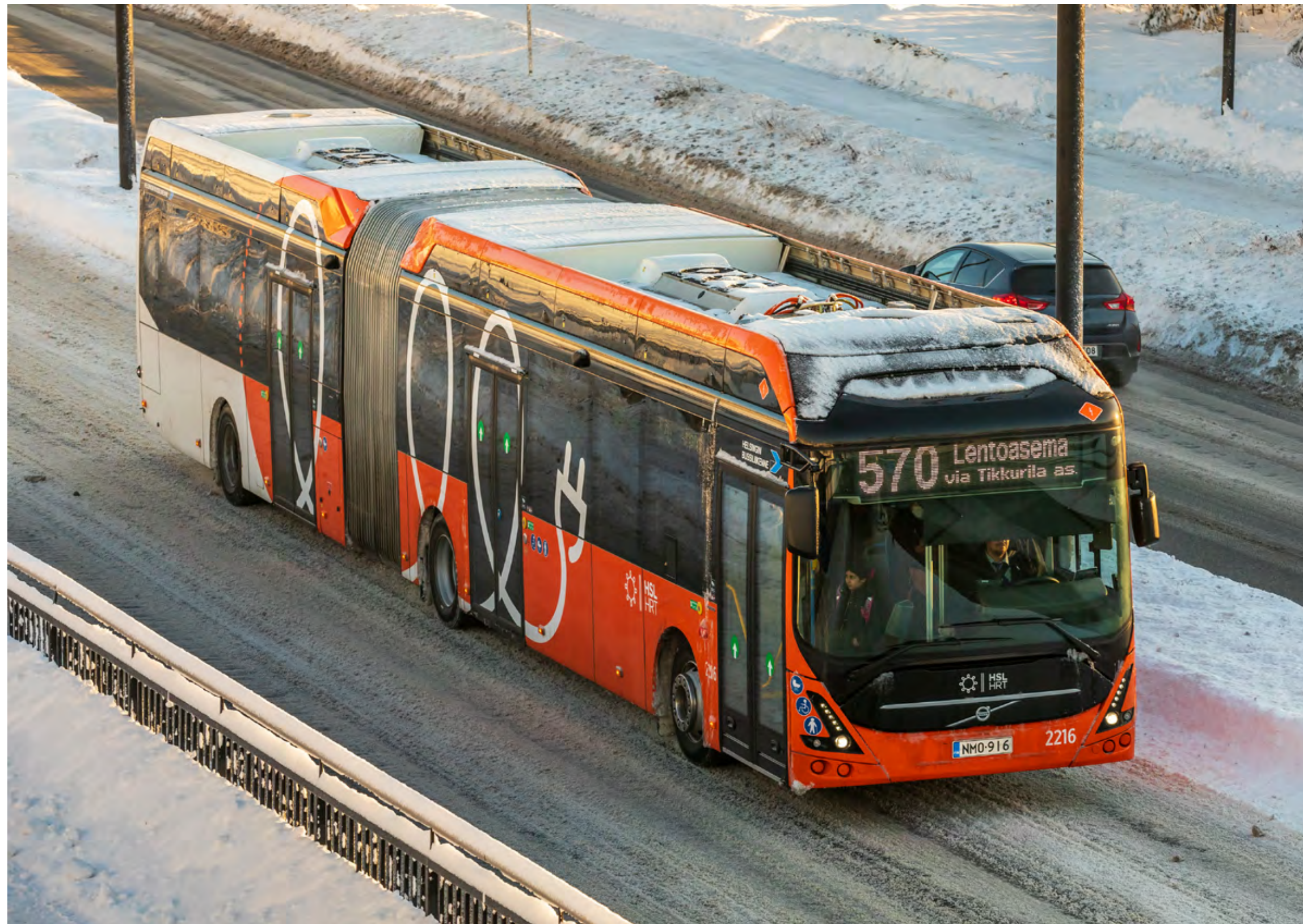
Kuva 5.3 Yksinivelinen sähköbussi runkolinjalla 570 joulukuussa 2022 (Kuvaaja: Simo Räsänen).
