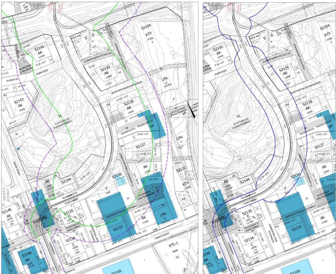
Kuva 24. Ratikan runkomelun riskialueet ilman vaimennusta, lila katkoviiva= riskialue 30 dB kerrostalo, vihreä viiva=riskialue 35 dB kerrostalo, sininen viiva=riskialue 45 dB pientalot ja kerrostalot (Sweco 2023, sisältää Maanmittauslaitoksen Maastotietokannan 01/2023 aineistoa).
