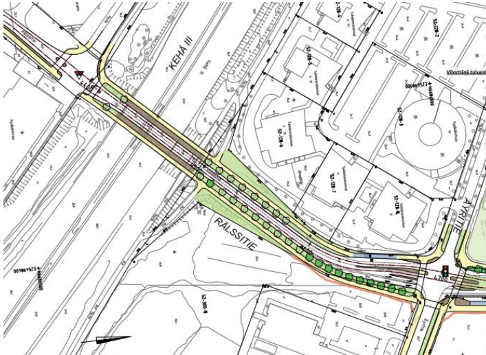
Kuva 15. Ote Vantaan ratikan yleissuunnitelmasta Rälssitieltä (WSP Finland 2019).
