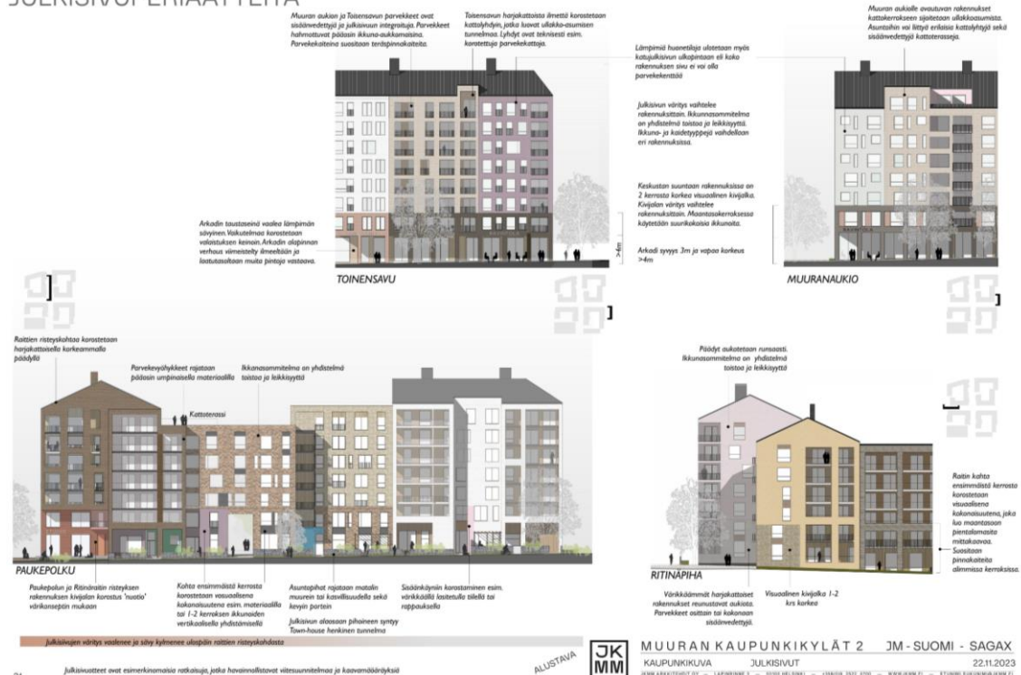
Kuva 43. Julkisivujen, arkadin ja kivijalan suunnittelun periaatteita (JKMM Arkkitehdit).
