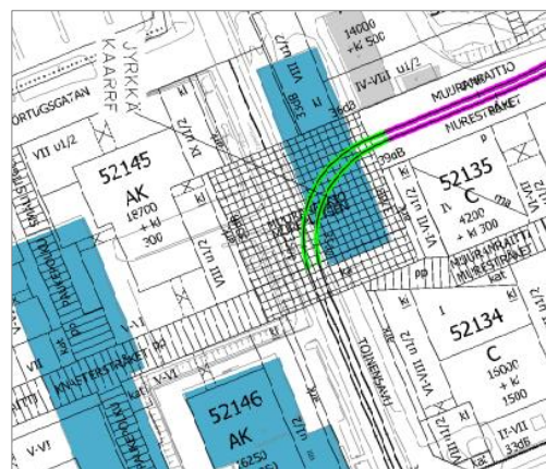
Kuva 27. Ratikan runkomelun vaimennus (Sweco 2023).
