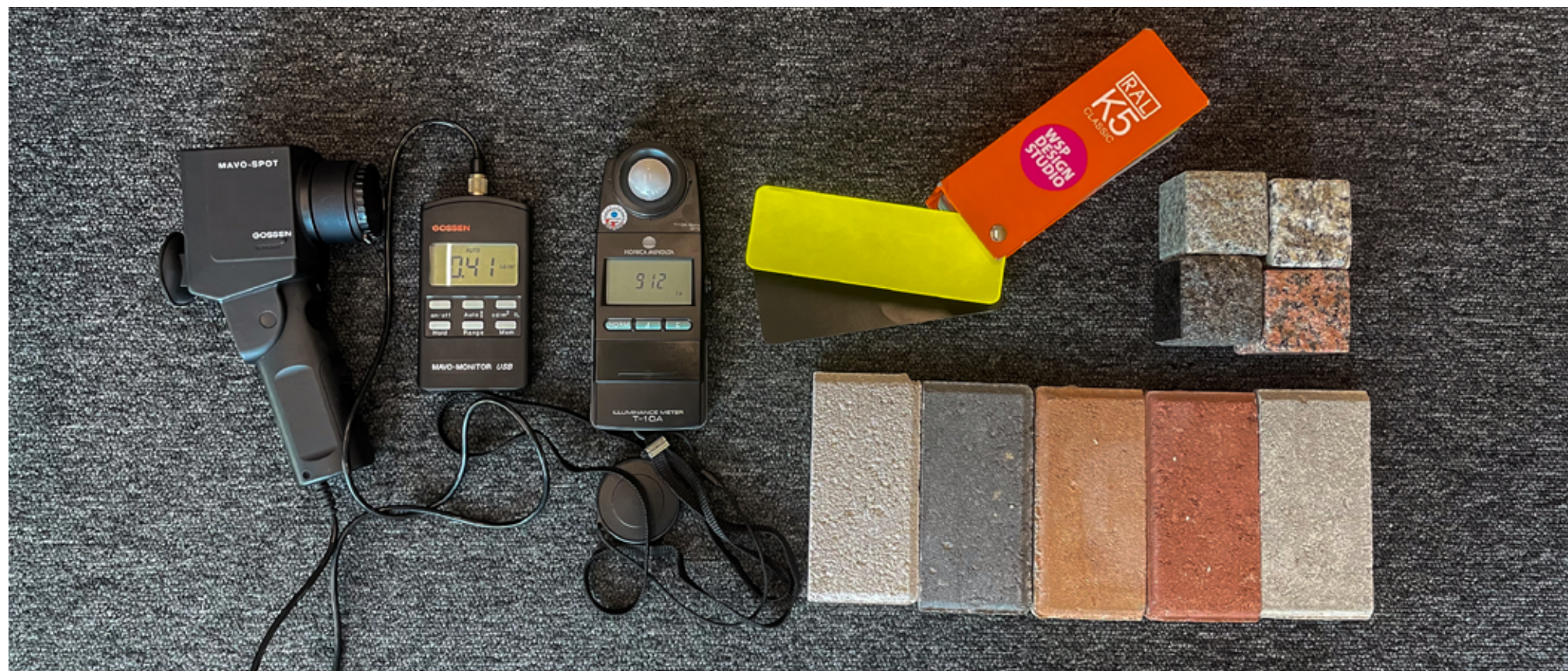
Mittauksissa käytettyjä laitteita (luminanssimittari ja luksimittari) ja näytepaloja.
