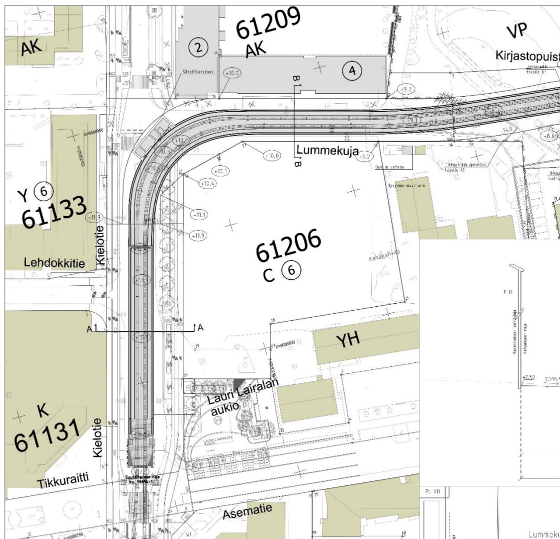
Kuva. Ratikka Kielotien ja Tikkurilanraition (maan alla Lummekujan kohdalla) katualueella. (Sitowise Oy, katusuunnitelma 23.3.2023.
