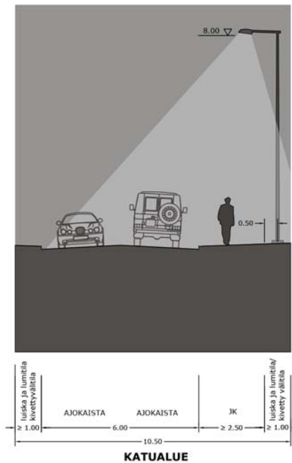
Kuva 18. Tonttikadun tyyppipoikkileikkaus työpaikka-alueella. (Tyyppipoikkileikkauksen pohja: Vantaan katutila -raportti 2010)
