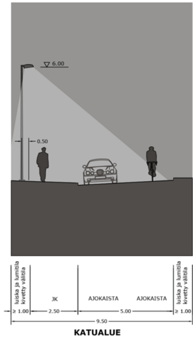
Kuva 16. Tonttikadun tyyppipoikkileikkaus pientaloalueella. (Tyyppipoikkileikkauksen pohja: Vantaan katutila -raportti 2010)
