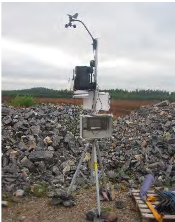
Kuva 2. Sääasema Davis Vantage Pro2 (kuva vastaavasta laitteesta eri toimintaympäristössä)
