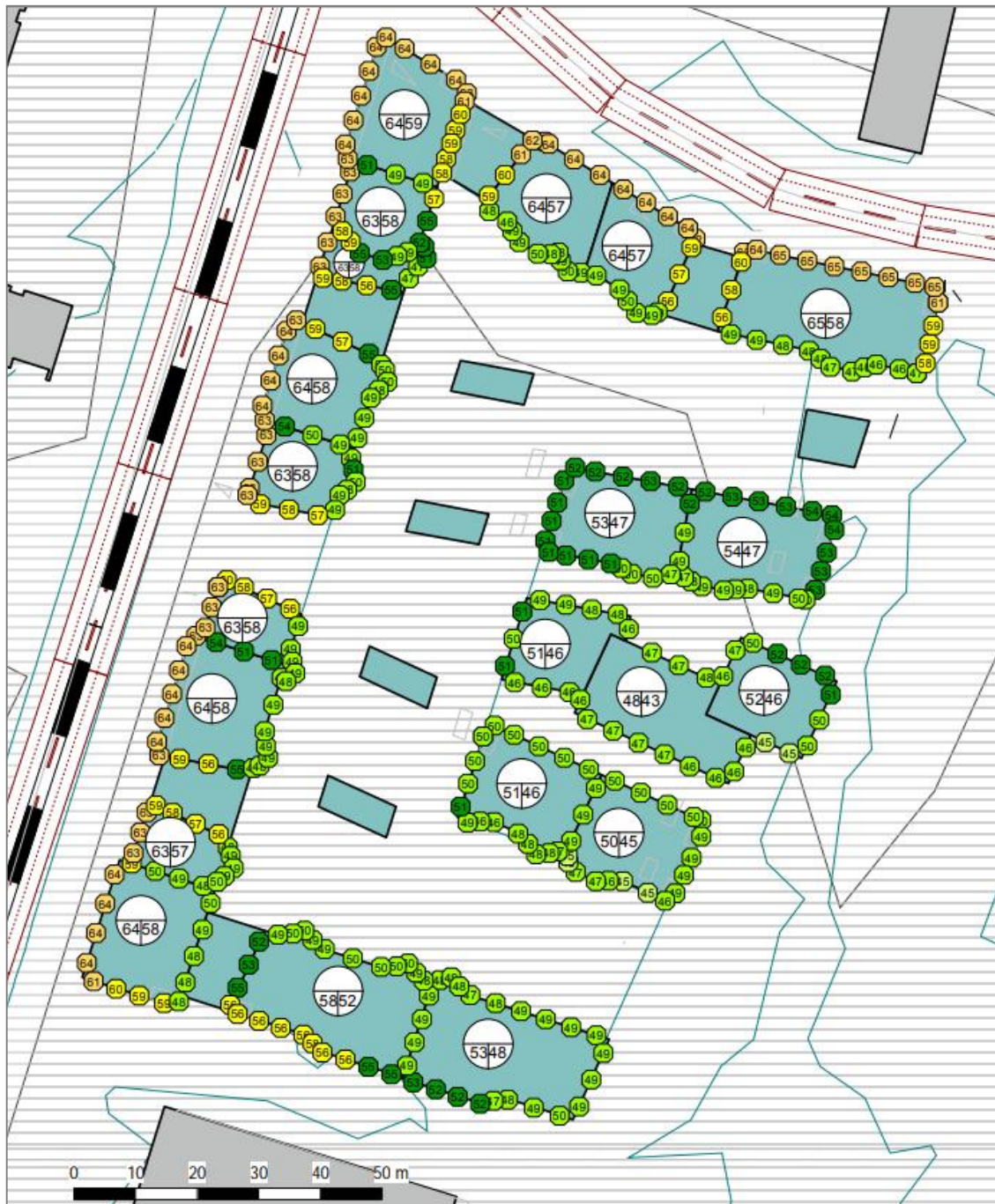
Päiväajan keskiäänitaso v. 2040 keskimääräisellä arkivuorokausiliikenteellä. Pienet ympyrät osoittavat julkisivun pystylinjaan kohdistuvan suurimman keskiäänitason / Helimäki Akustikot.
