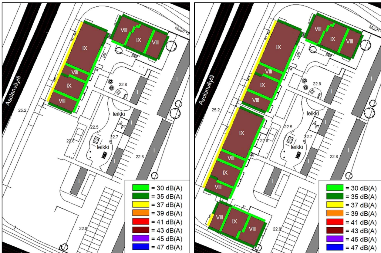
Kuva 5. Asuinhuoneistojen julkisivujen ääneneristävyysvaatimukset rakentamisen eri vaiheissa.
