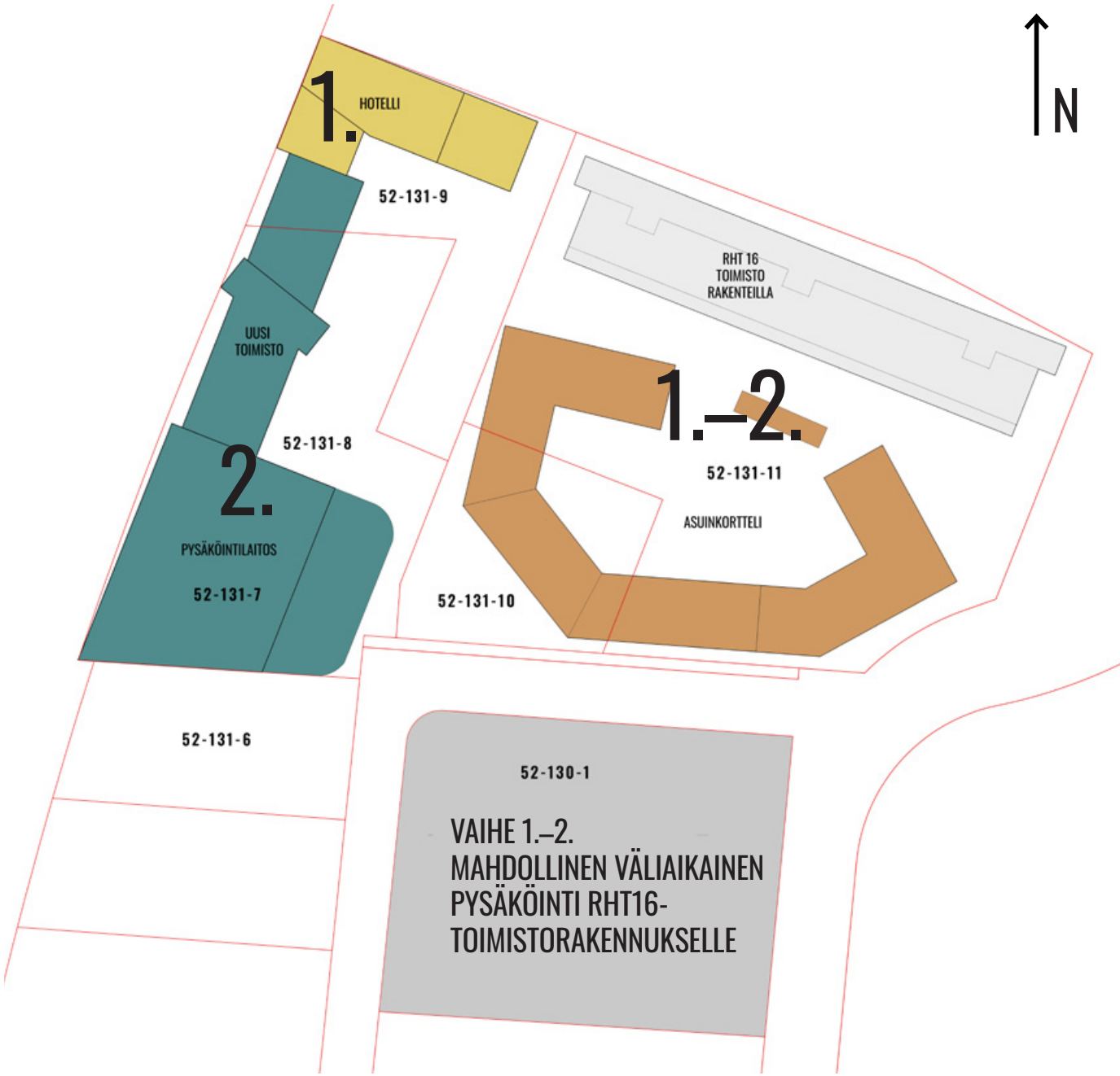
Kaavio 22b. Rakentamisen vaiheistus.
