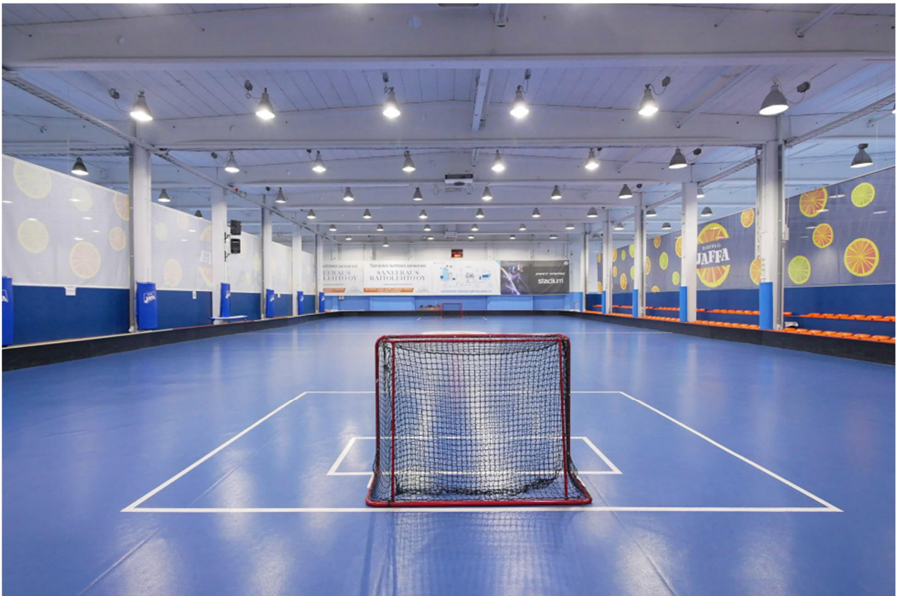
Teollisuushalli on muutettu salibandytilaksi, kuvassa keskimäinen halli pilaririveineen.
