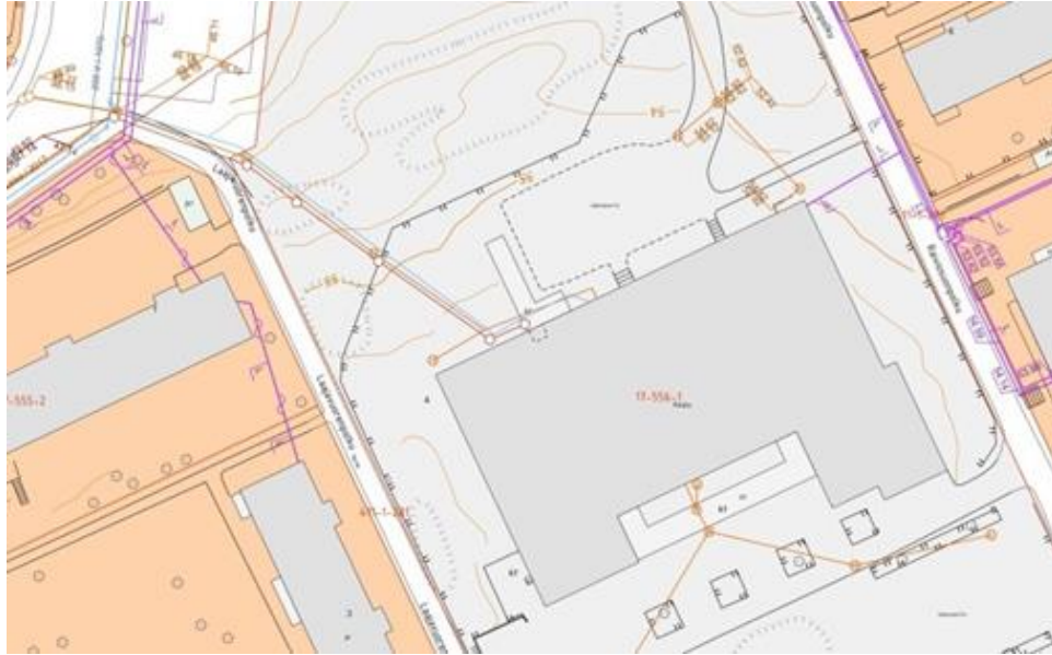
Kuva 1; nykyiset kaukolämpö-, vesi-, viemäri- ja hulevesitonttijohdot
