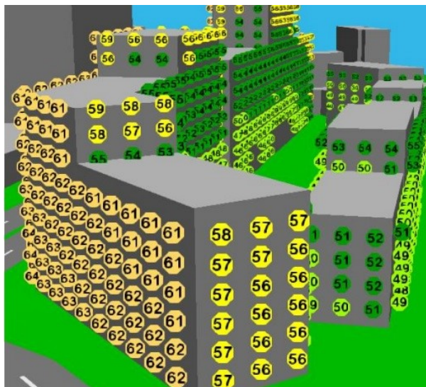
Julkisivuihin kohdistuvat melutasot. Etelän puoleiset julkisivut.
