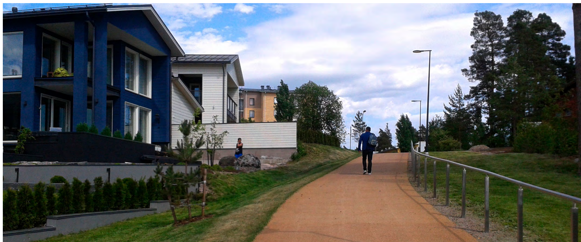
Jyrkässä rinteessä on hyvä käyttää kivituhkan sijaan kestopäällystettä, joka ei ole altis eroosiolle. Kuvassa keltasävyinen kivisirotepinta.
