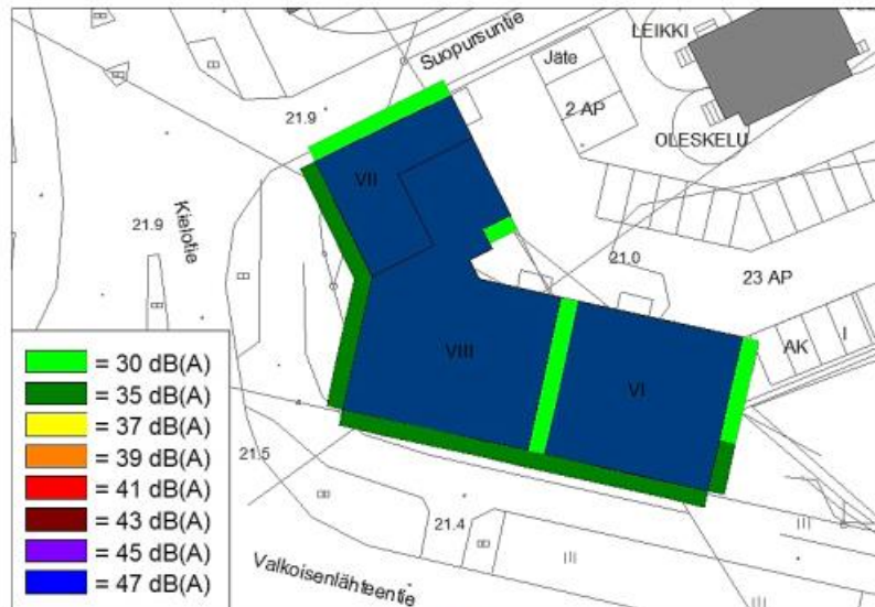
Kuva 3. Asuinhuoneistojen julkisivujen äänitasoerovaatimukset liikenteen melua vastaan.
