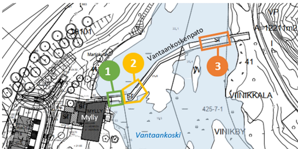
Padon osittainen purkaminen, alustava suunnitelma.
