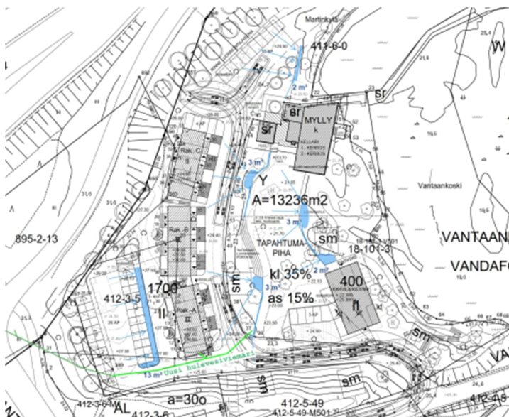
Hulevesien hallintasuunnitelma, esimerkki hulevesien hallitsemiseksi tontilla. Elina Kettunen 12.4.2022
