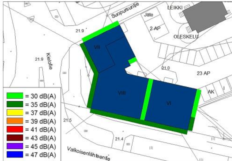
Kuva 3. Asuinhuoneistojen julkisivujen äänitasoerovaatimukset liikenteen melua vastaan.
