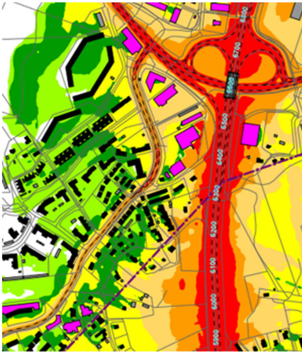
1. Nykytilanne, tie- ja katumelu. Nykyinen meluntorjunta. Päiväajan klo 7–22 keskiäänitaso (Laeq) 2 m korkeudella maanpinnasta. Ramboll 11.5.2020
