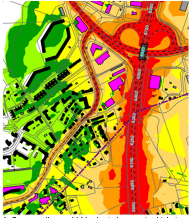
2. Ennustetilanne 2030, tie- ja katumelu. Nykyiset liikennejärjestelyt ja nykyinen meluntorjunta. Päiväajan klo 7–22 keskiäänitaso (Laeq) 2 m korkeudella maanpinnasta. Ramboll 22.5.2020
