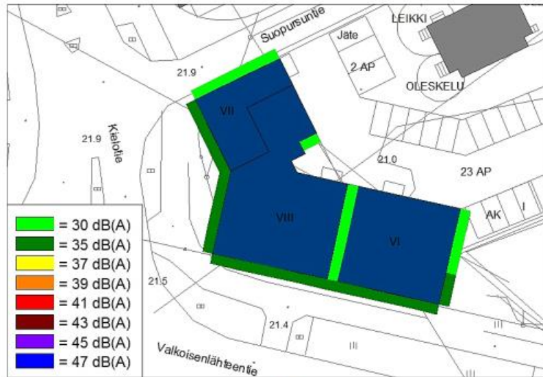
Kuva 3. Asuinhuoneistojen julkisivujen äänitasoerovaatimukset liikenteen melua vastaan.
