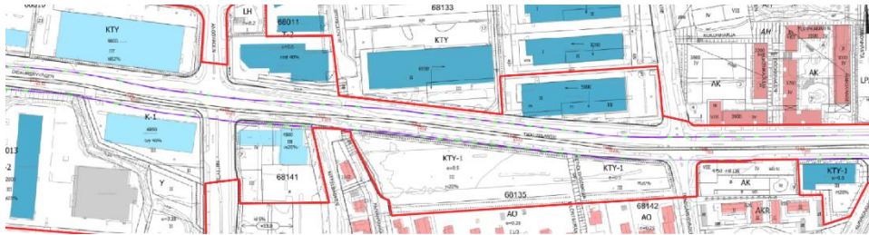
Kuva 27. Raitiovaunuliikenteen aiheuttamat runkomelualueet kaava-alueen itäosassa paaluvälillä 6400–7200. (Sweco, 23.5.2022)
