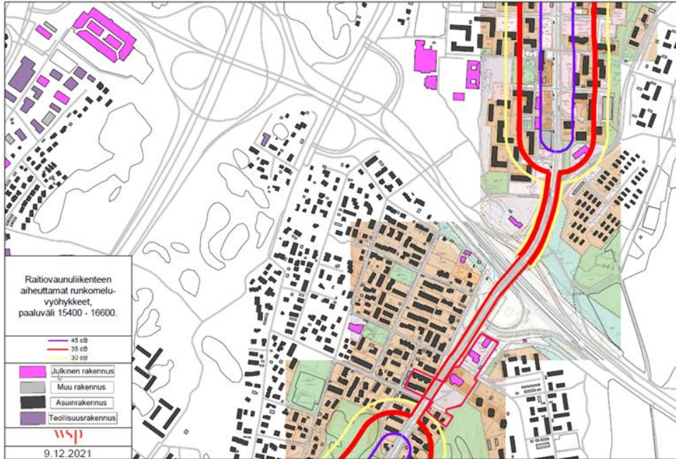
Kuva 33. Raitiovaunuliikenteen aiheuttamat runkomelualueet Hakunilan eteläosassa ja Vaaralan pohjoisosissa, paaluväli 15400–16600 (Tärinä- ja runkomeluserelvitys, WSP Finland Oy ja Afry Finland Oy, 25.2.2022). Kaava-alue on osoitettu pinkillä viivalla.
