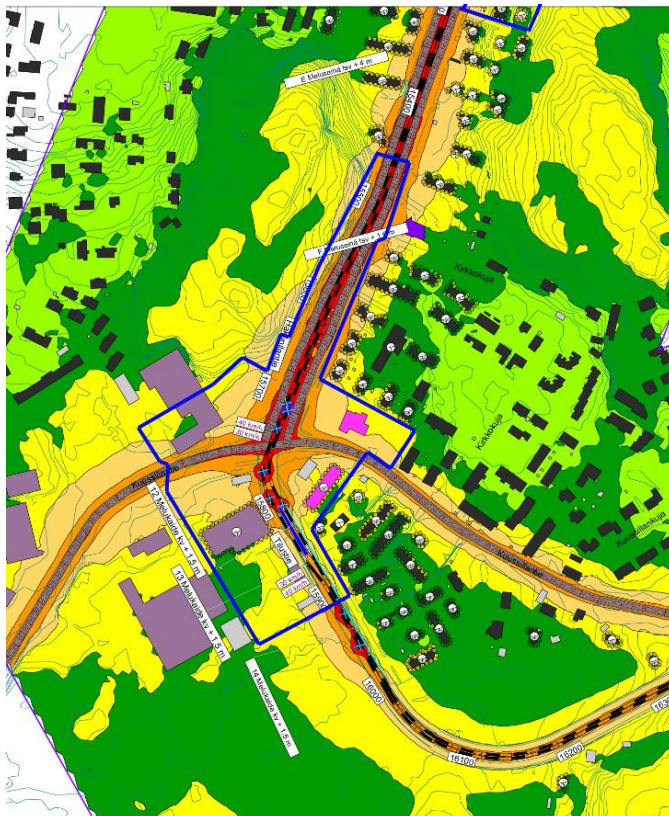
Kuva 32. Ote tieliikennemelun ja raitiotien yhteismelun päiväaikaisesta ennustetilanteesta Tilustiellä, jonne on esitetty melusuojaksi melukaiteita. (Sitowise Oy 31.8.2022)
