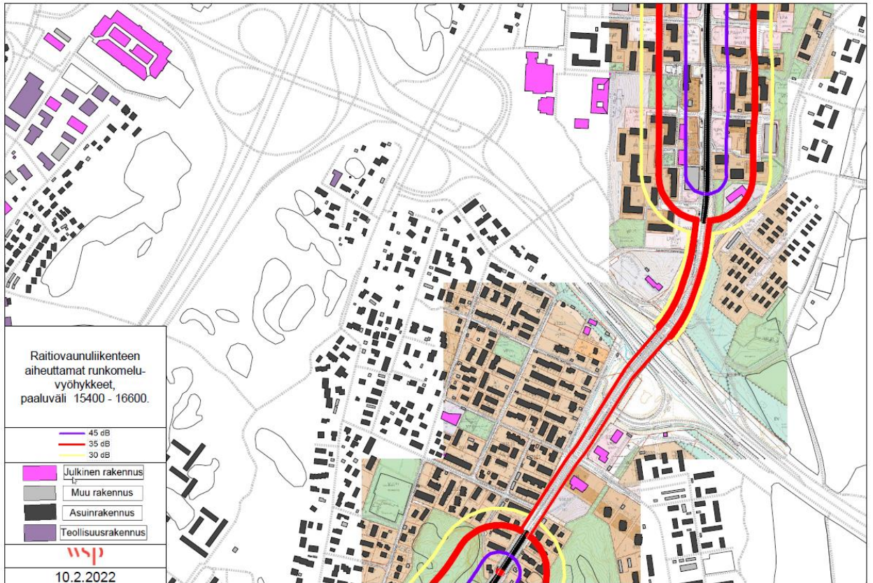
Kuva 30. Raitiovaunuliikenteen aiheuttamat runkomelualueet Hakunilantien eteläosassa ja Vaaran pohjoisosissa, paaluväli 15400–16600 (Tärinä- ja runkomeluselvitys, WSP Finland Oy ja Afry Finland Oy, 25.2.2022).
