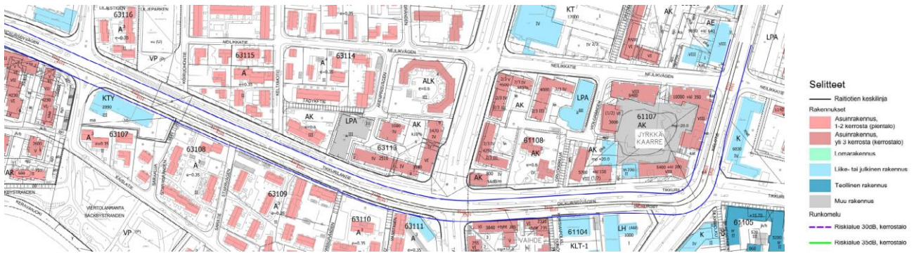
Kuva 32. Raitiovaunuliikenteen aiheuttamat runkomelun riskialueet Tikkurilantiellä Kielotien ja Viertolan koulun välillä. (Sweco, 23.5.2022)
