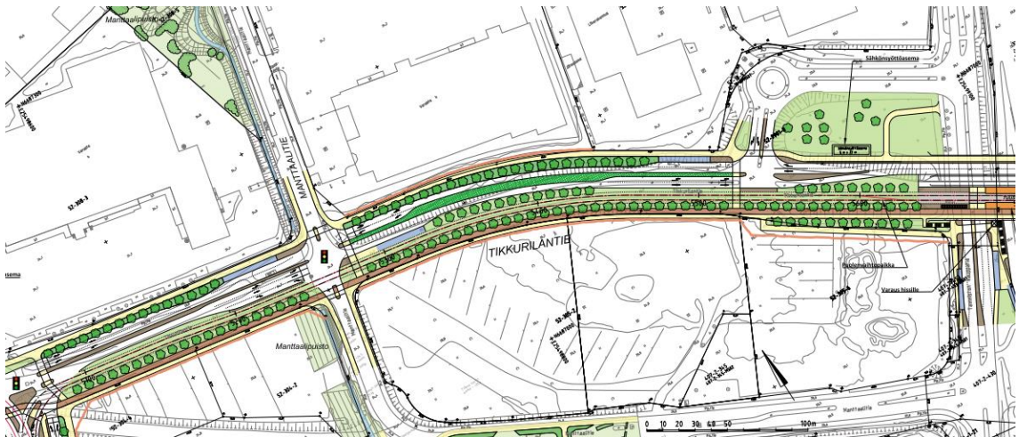
Kuva 19. Ote Vantaan ratikan yleissuunnitelmasta Tikkurilantieltä. Tikkurilantien linja-autopysäkit näkyvät kuvassa sinisellä. (WSP Finland 2019)
