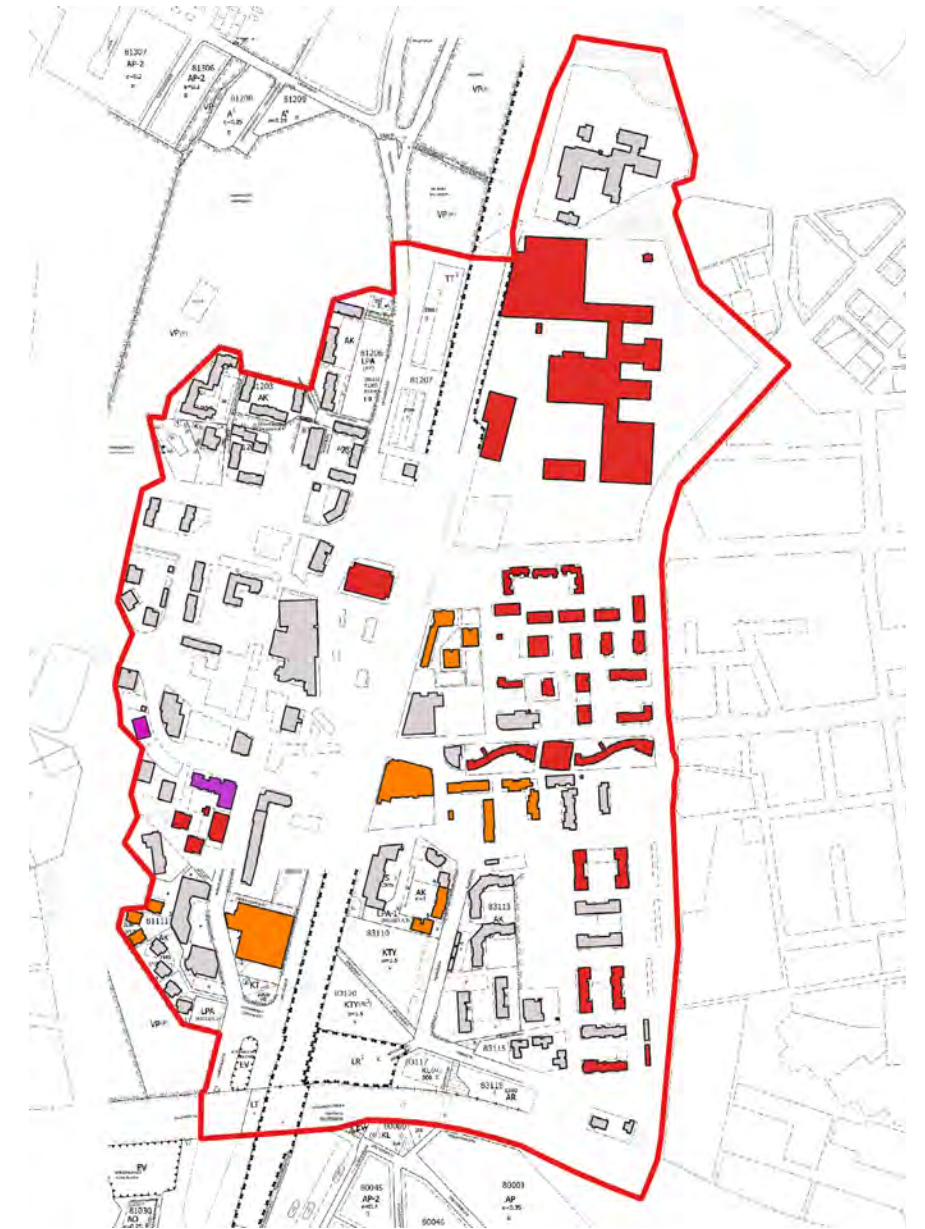
Kuva 13. Rakennusten perustamistavat. Punainen = paaluperustus, oranssi = maanvarainen/paaluperustus, harmaa = maanvarainen tai ei tietoa perustamistavasta. (02/2023) Lähde: Vantaan kaupunki.
