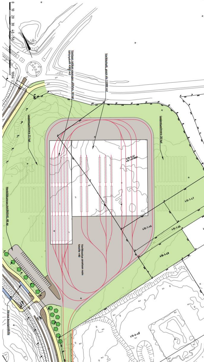
Kuva 20. Ote Vantaan ratikan yleissuunnitelmasta (WSP Finland, 30.4.2019). Kuva ratikan varikon alueella. Säilytyshallin koko on 4300m 2 ja varikkohalli 11 000m 2 . Länsimäentien varrella on varaukset bussipysäkeille.
