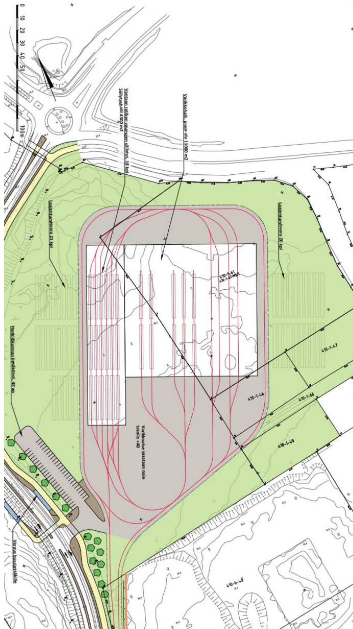
Kuva 20. Ote Vantaan ratikan yleissuunnitelmasta (WSP Finland, 30.4.2019). Kuva ratikan varikon alueella. Säilytyshallin koko on 4300m 2 ja varikkohalli 11 000m 2 . Länsimäentien varrella on varaukset bussipysäkeille.
