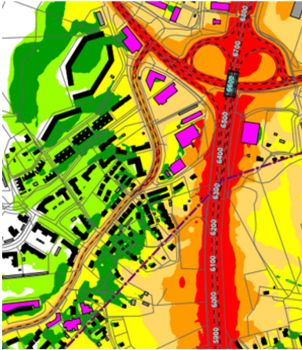
1. Nykytilanne, tie- ja katumu. Nykyinen meluntorjunta. Päiväajan klo 7–22 keskiäänitaso (Laeq) 2 m korkeudella maanpinnasta. Ramboll 11.5.2020
