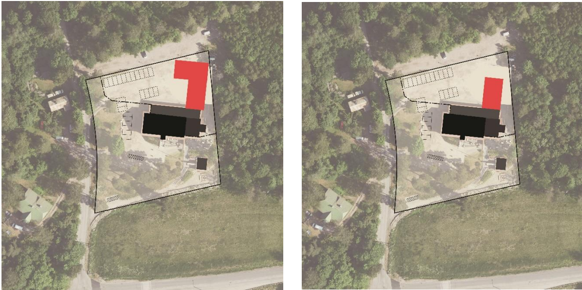
Kuva 28. Jäljellä olevaa rakennusoikeutta vastaavan yksikerroksisen (vasemmalla) ja kaksikerroksisen rakennuksen (oikealla) esimerkkisijoittelu rakennusalalle. Uudisrakennusosa on esitetty punaisella. Täyden rakennusoikeuden vaatimat 24 pysäköintipaikkaa autoille ja pyörille on esitetty mustina suorakulmioina.
