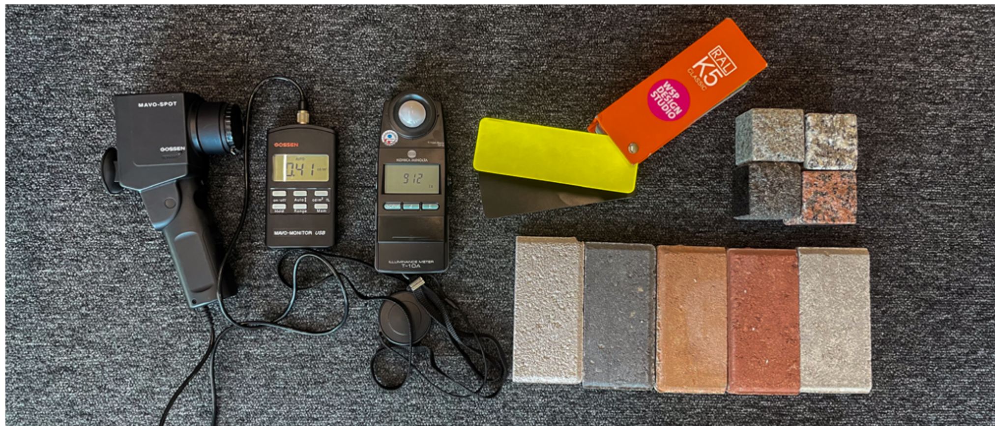
Mittauksissa käytettyjä laitteita (luminanssimittari ja luksimittari) ja näytepalloja.
