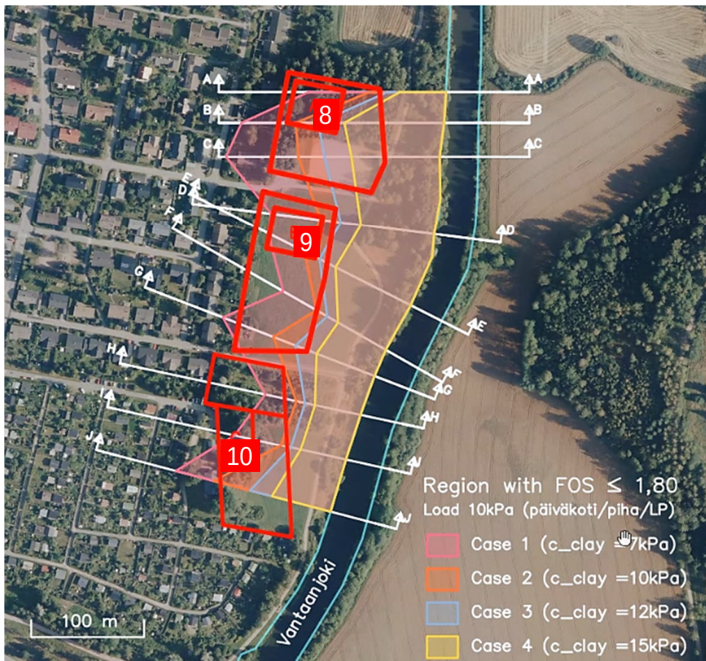
Alustava maaperän stabiiliteetin tarkastelu Vantaanjoen suuntaan saven eri leikkauslujuuksilla.
