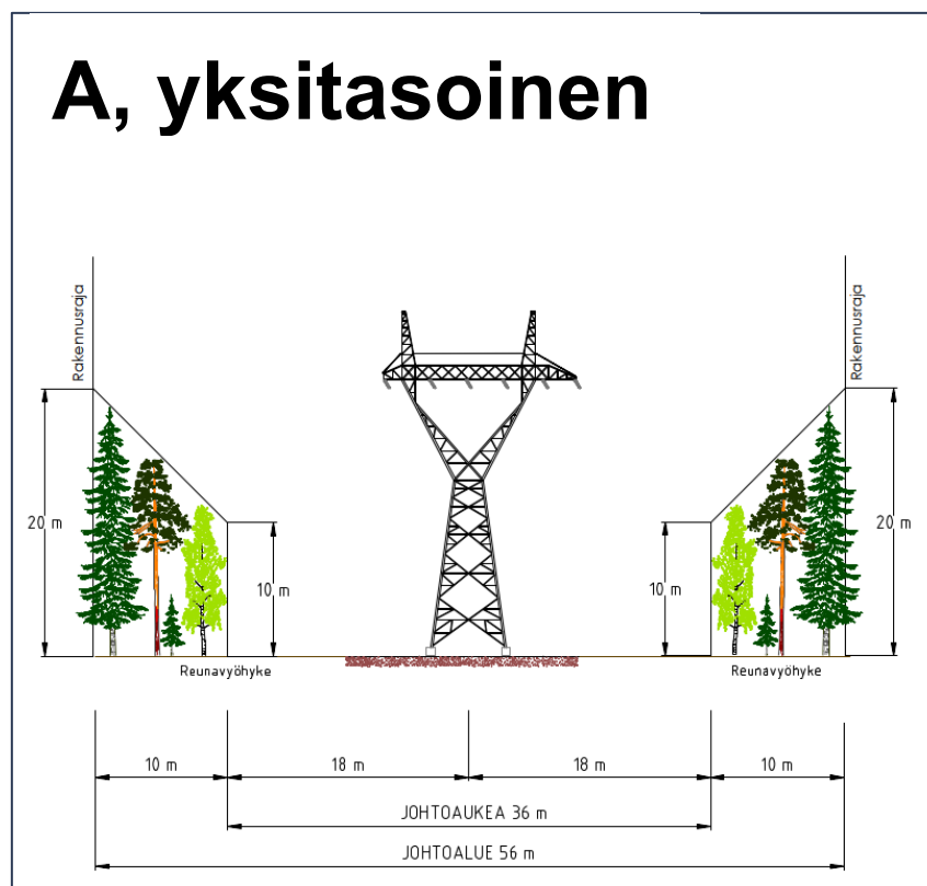
Kuva 6. Johtoalueen kuva Seutulan pelloilla käytettävästä yksitasoisesta pylväästä.
