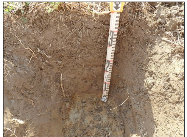
Vasemmalla: Sama koekuoppa luoteeseen, eli Vantaanjoelle päin kuvattuna. Joki on kuvassa näkyvän puuston ja pusikoiden kohdalla. Oikealla: Maat koekuopassa: noin 30 cm paksun kyntökerroksen alla on tiivis ja puhdas savi, jota on kaivettu noin 5 cm verran.
