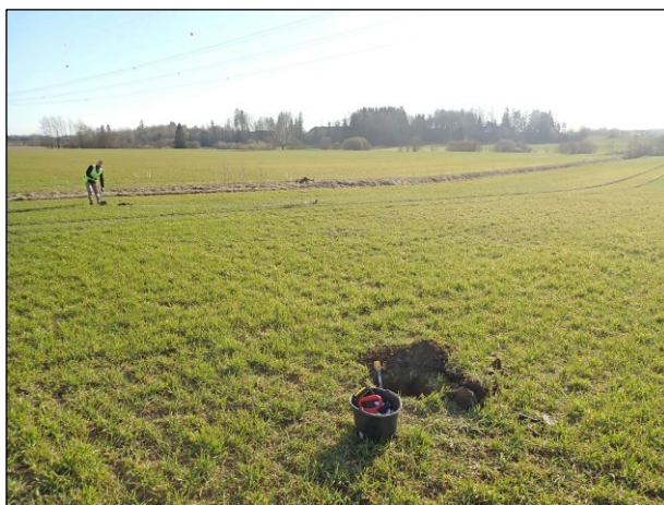
Vasemmalla: Koekuoppa suunnitellun pylväänpaikan D sijaintipisteen kohdalla, noin länteen kuvattuna. Taka-alalla, pusikoiden rivin kohdalla on Vantaanjoki. Oikealla: Maat koekuopassa. Noin 30 cm paksun kyntökerroksen alla on tiivis ja puhdas savi.
