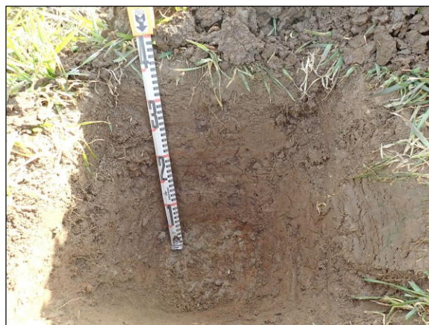
Vasemmalla: Koekuoppa suunnitellun pylväänpaikan D sijaintipisteen kohdalla, noin länteen kuvattuna. Taka-alalla, pusikoiden rivin kohdalla on Vantaanjoki. Oikealla: Maat koekuopassa. Noin 30 cm paksun kyntökerroksen alla on tiivis ja puhdas savi.
