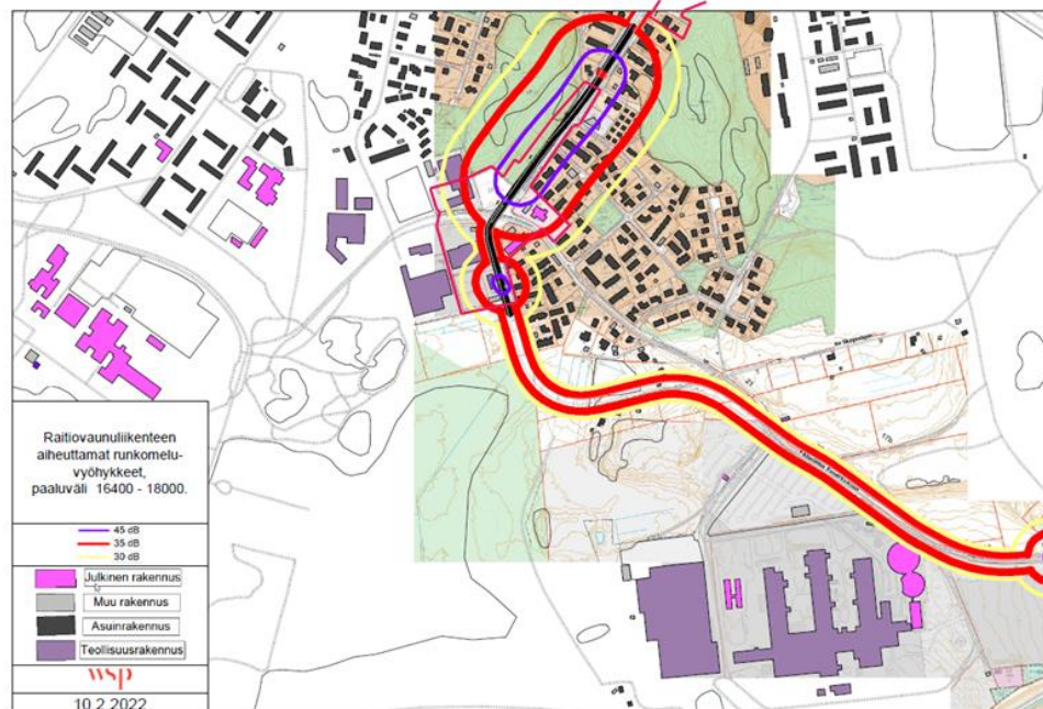
Kuva 34. Raitiovaunuliikenteen aiheuttamat runkomelualueet Vaaralan ja Kuussillan alueilla, paaluväli 16400–18000 (Tärinä- ja runkomeluserelvitys, WSP Finland Oy ja Afry Finland Oy, 25.2.2022). Kaava-alue on osoitettu pinkillä viivalla.
