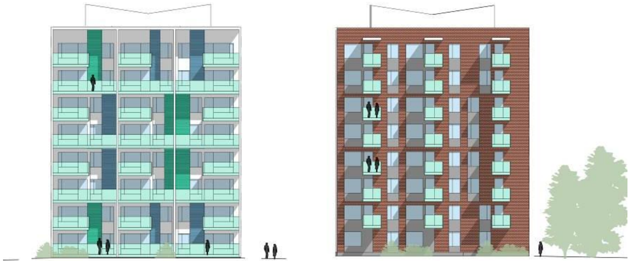
Arkkitehtitoimisto Helamaa-Pulkisen pistetalojen pohjalta muokattuja julkisivuja, joissa runkoa on kavennettu yhdellä asunnolla /kerros.
