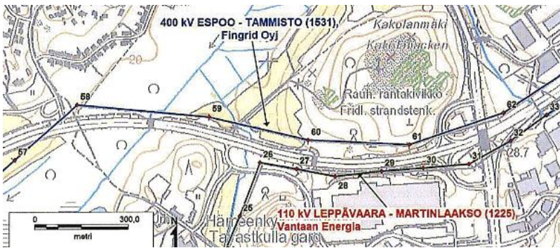
Kuva 1. Asemakaava-alueelle sijoittuvat voimajohdot. Fingrid Oyj:n 400 kV voimajohto on merkitty sinisellä viivalla. Kuvaan on merkitty myös numeroidut voimajohtoreitin pylvää.
